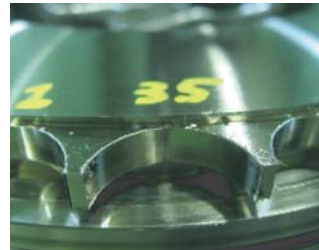
●7.4m 加工後のワークの状態 After cutting 7.4 m
